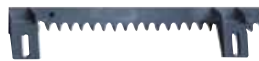
CREM 3 (1 METRO) Cremallera plastificada con interior metálico, M4 28x22x1000 mm, incluye tornillería.
