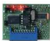
Edge OC2 Receptor Edge. 2 canales.
